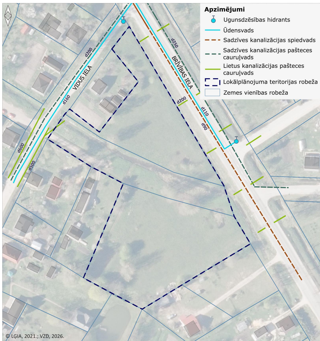
21. attēls. Inženiertīklu pieejamība – centralizētā ūdensapgāde un sadzīves kanalizācija, ārējā ugunsdzēsība un lietus kanalizācija. Kartoshēma ir sagatavota, izmantojot augstas detalizācijas topogrāfiskā plāna M 1:500 informāciju
